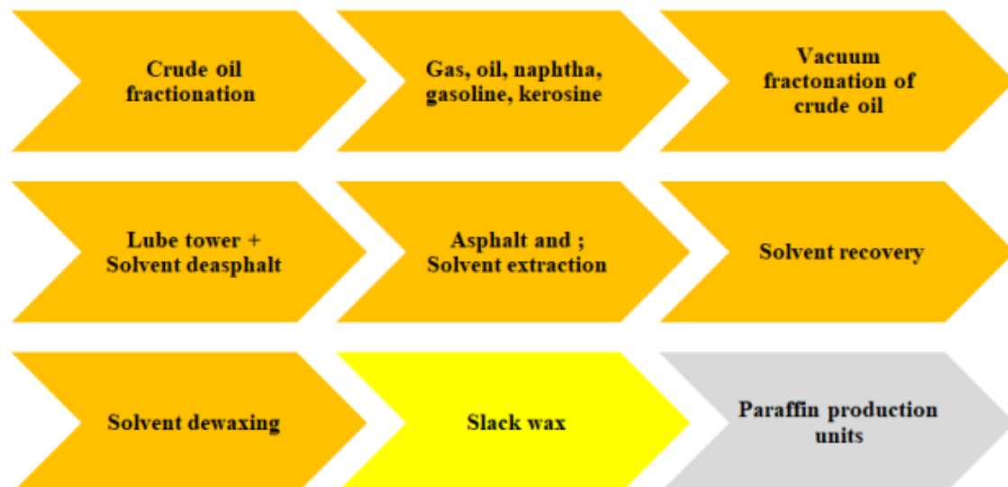
Рисунок 1.1 – Компоновка процесів при виробництві парафінів
