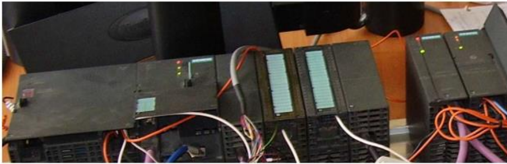
Рисунок 4.1 - Випробувальний стенд PROFIBUS для п'яти датчиків одного бака.
