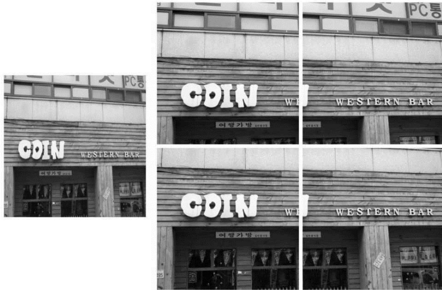
Рисунок 3.18 - Приклад попередньої обробки зображення (ліворуч - зображення, стиснуте до розмірів 384*384 пікселя, праворуч - частини зображення розміром 384*384 пікселя)
