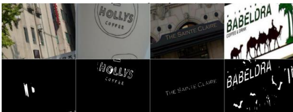
Рисунок 3.11 - Найгірші маски для тестових зображень, отримані з мережі максимальної точності (зверху – оригінал зображення, знизу – результат навчання з фільтрацією)
