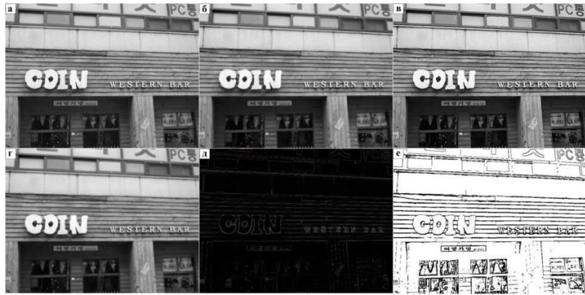
Рисунок 3.6 - Передобробка зображення: а - без фільтрів, б - двосторонній фільтр згладжування з коефіцієнтом 50; фільтр різкості, що виділяє краї, е - двосторонній фільтр згладжування з коефіцієнтом 50 та фільтр виділення країв
