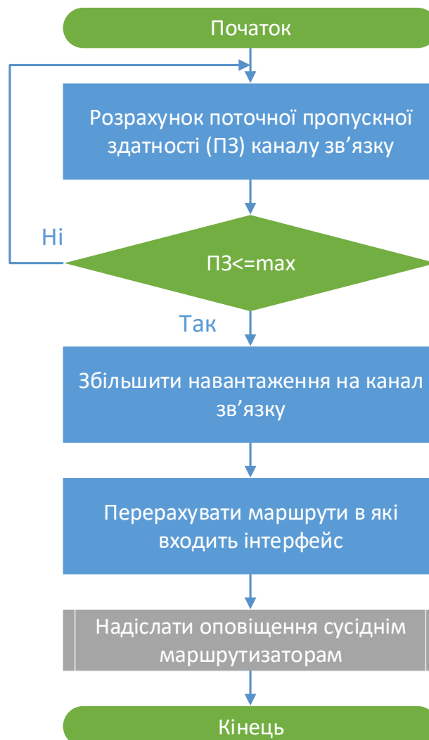
Рис. 2.3. Блок-схема алгоритму стеження за поточною здатністю каналу зв'язку
