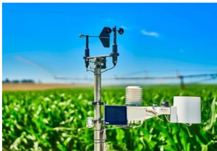
Рис.1.1. Ручний та стаціонарний варіант анемометра для вимірювання швидкості вітру
