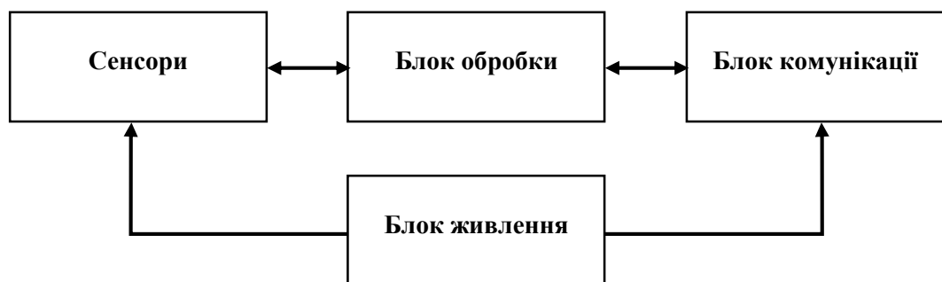
Рис. 2.6. Типова структурна схема сенсорного вузла
