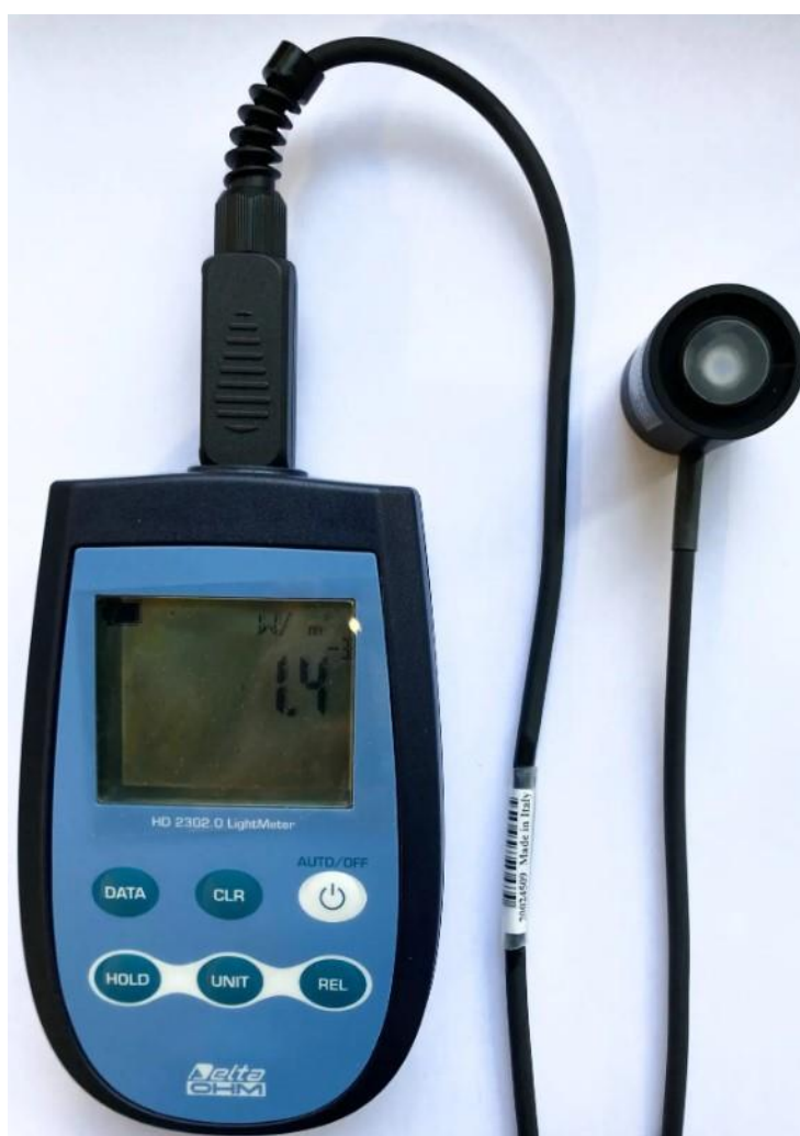
Рис. 1.6. Портативний вимірювач інтенсивності УФВ HD2302.0 [12]
