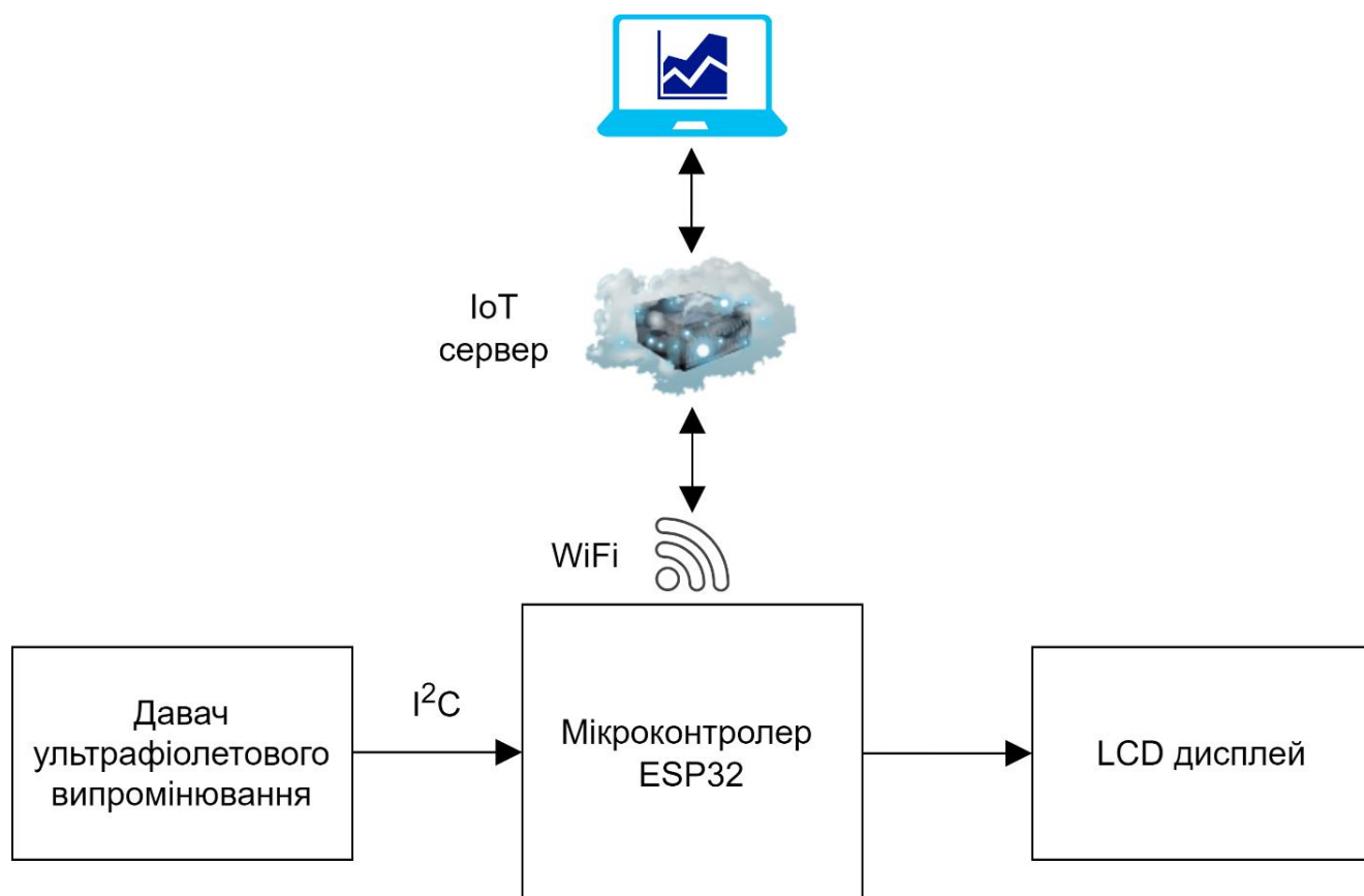
Рис. 3.1. Структурна схема системи дистанційного контролю інтенсивності УФВ
