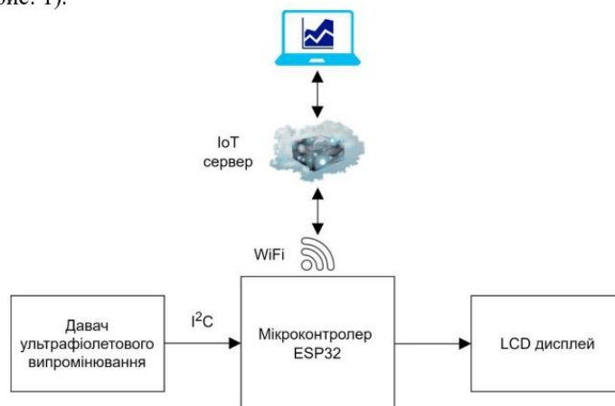
Рисунок 1. Структура системи дистанційного контролю інтенсивності УФ випромінювання
