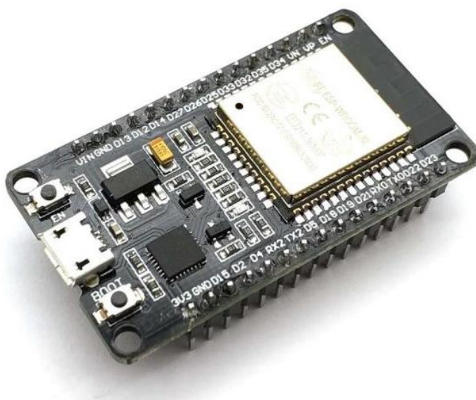
Рис. 3.3. Мікроконтролерний модуль ESP32 DEV KIT
