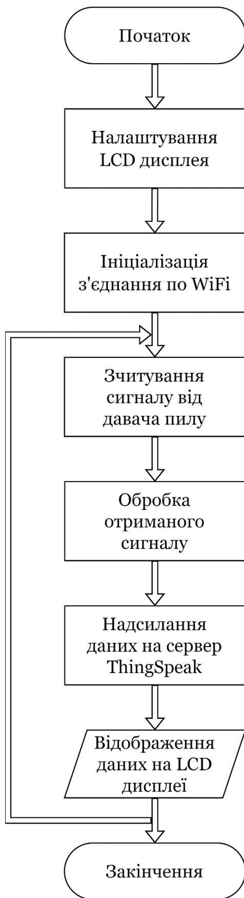
Рис. 3.6. Блок-схема алгоритму роботи програми для мікроконтролера ESP8266 системи моніторингу концентрації пилу
