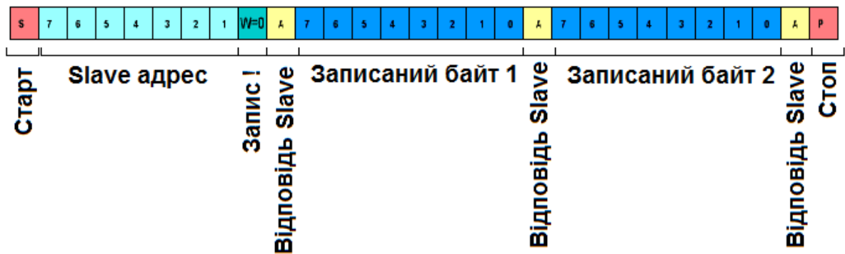
Рис. 2.9. Побітний процес обміну інформацією по шині I2C
