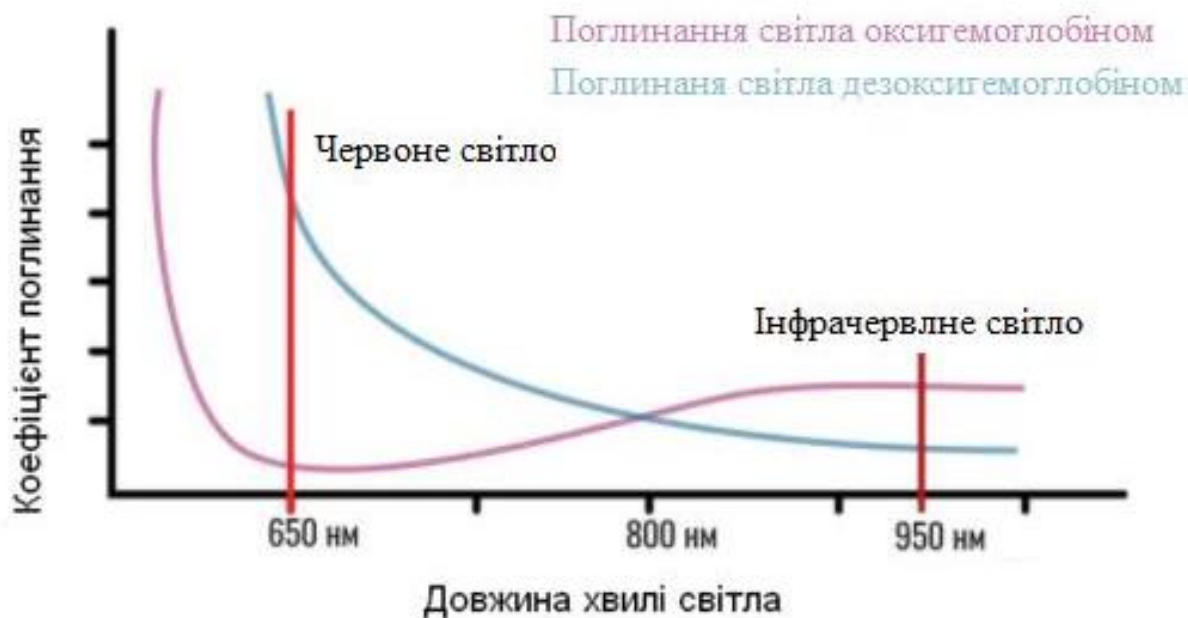
Рис. 2.2. Спектр поглинання світла дезоксигемоглобіном та оксигемоглобіном
