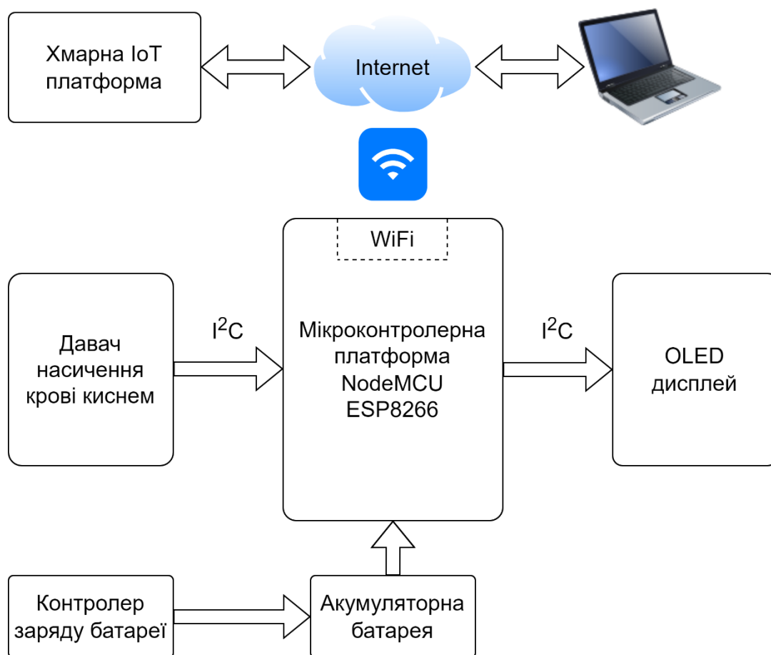
Рис. 3.1. Структура системи віддаленого моніторингу рівня НКК людини
