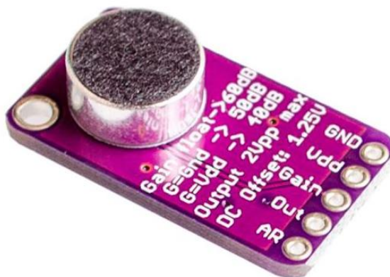
Рис. 3.4. Зовнішній вигляд модуля мікрофона MAX9814
