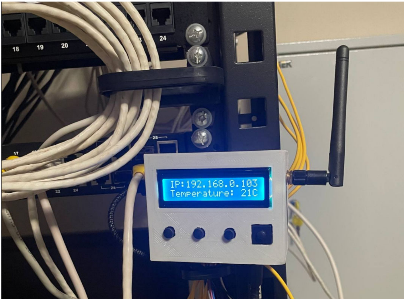
Рис. 3.27. Змонтований блок моніторингу в серверній
