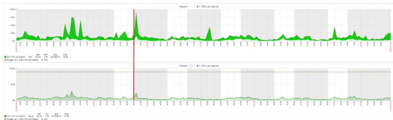
Рис. 3.22 Вплив системи моніторингу на навантаження на процесор роутера
