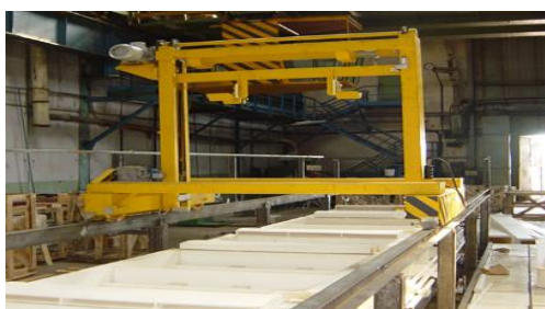
Рис. 1.5 Зовнішній вигляд порталної лінії для гальванічного покриття деталей
