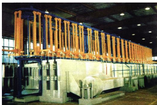
Рис. 1.2 Зовнішній вигляд кареткової лінії для гальванічного покриття деталей
