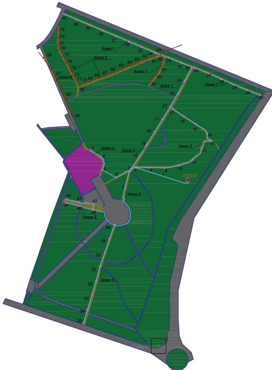
Рисунок 2.22 – Схема електричної мережі модернізованої системи освітлення парку «Національного Відродження»
