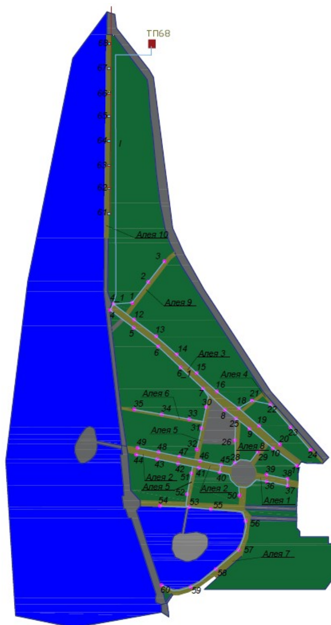
Рисунок 2.21 – Схема електричної мережі модернізованої системи освітлення парку «ім. Т.Г. Шевченка»
