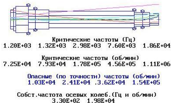
Рис. 3.4 – Аналіз компоновки шпиндельного узла
