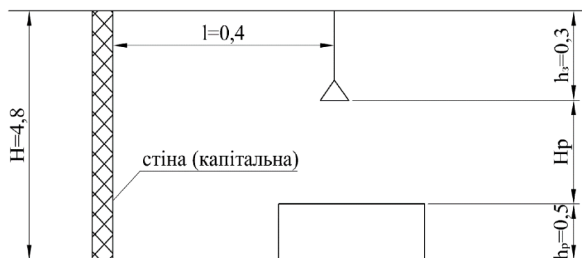
Рисунок 4.2. Схема розрахунку освітленості точковим методом
