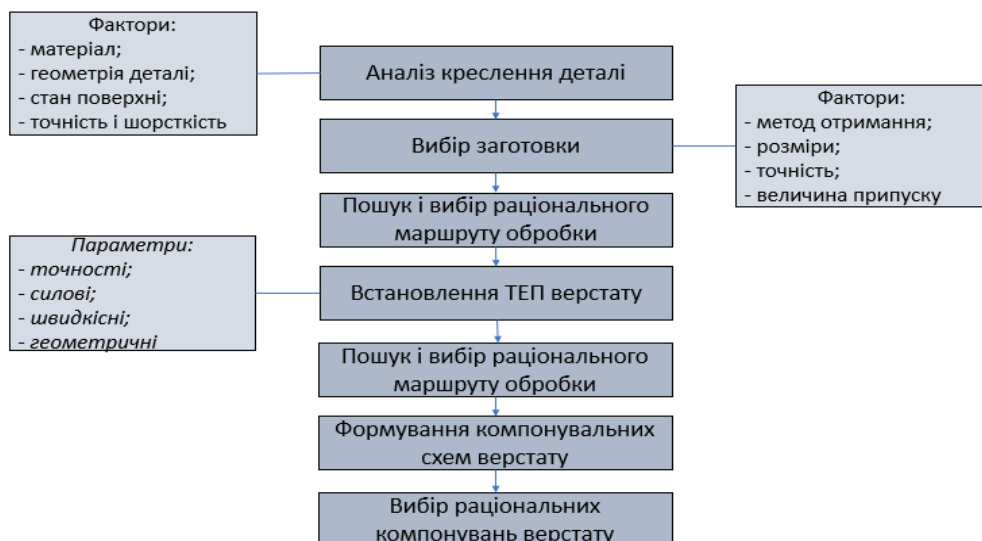
Рис. 3.6. Узагальнений алгоритм проектування БТА на початкових етапах
