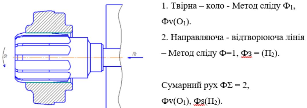
Рис. 2.5. Формоутворення при обробці кінцевим інструментом
