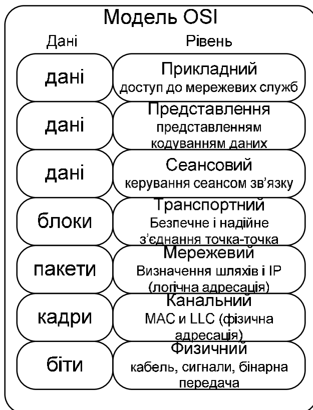
Рисунок 1.1 – Еталонна модель OSI
