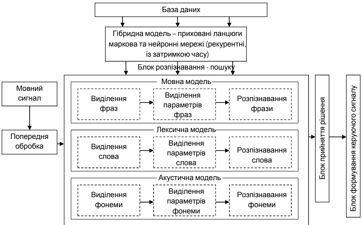
Рис. 5.1. Функціональна схема системи розпізнавання мови
