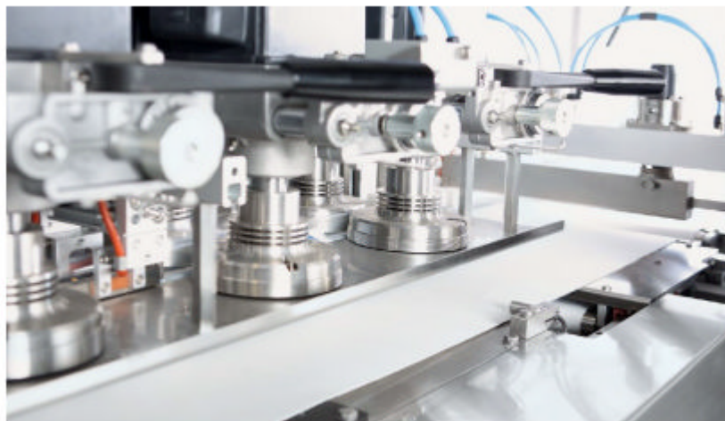
Рис. 2.3. Приклад блоку зварювальних коліс у горизонтальній обгортковій машині.
