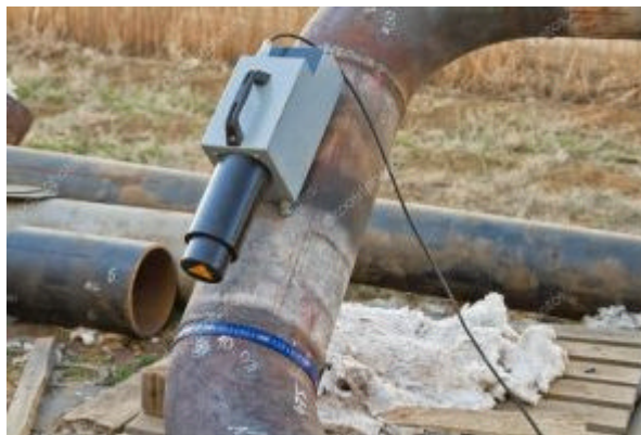
Рис. 1.6. Радіографічний (чи радіаційний) метод контролю зварного шва труби
