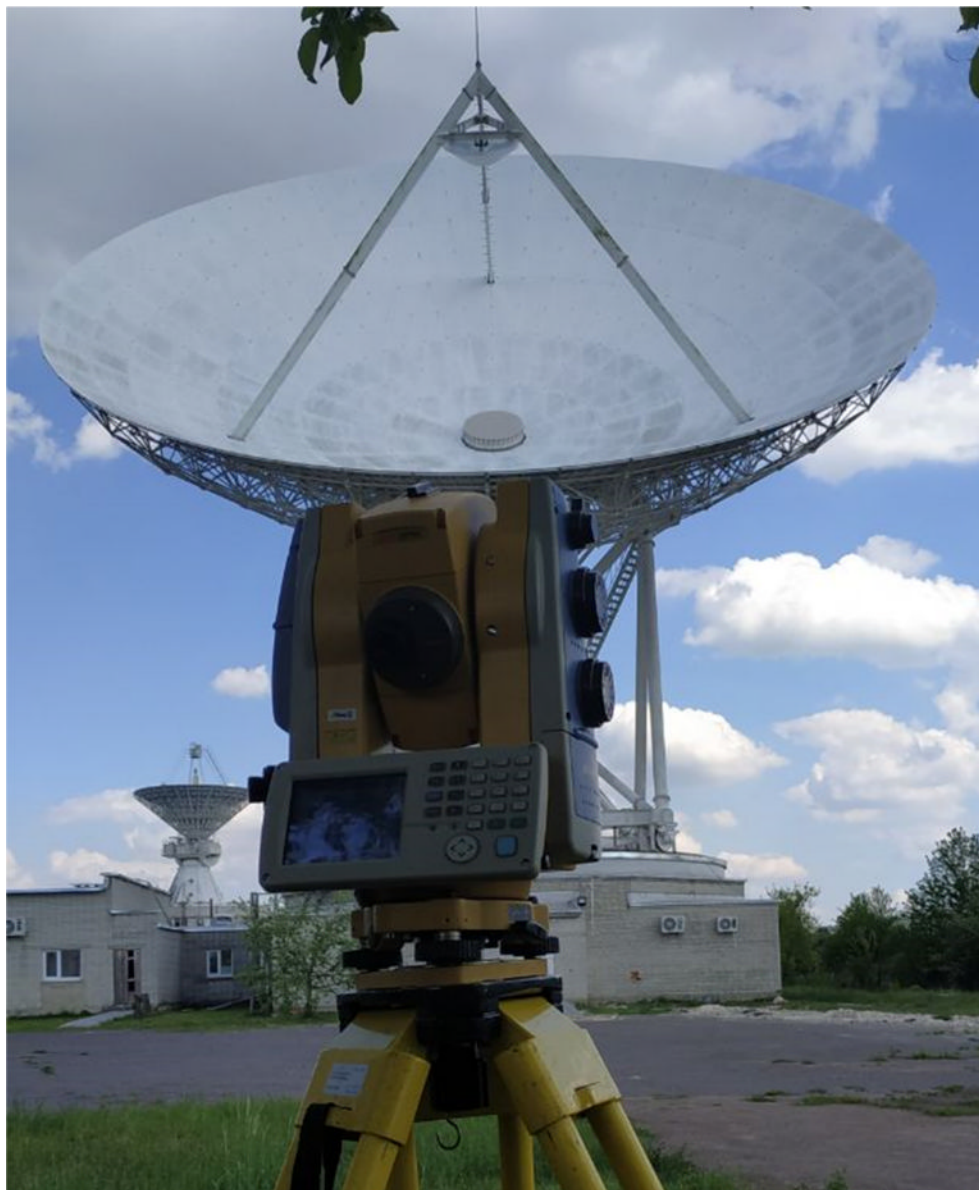
Рисунок 3.4 - Контроль профілю великогабаритної антени лазерним далекоміром
