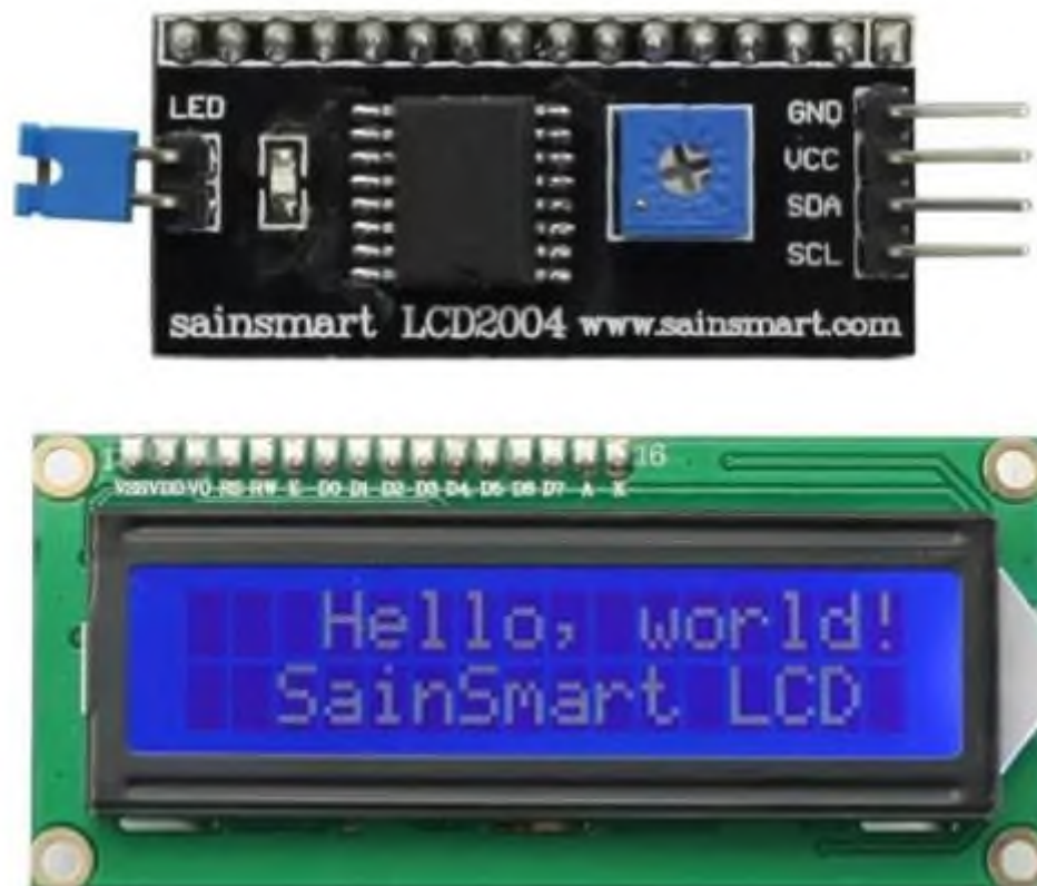
Рисунок 4.5 –Зовнішній вигляд LCD-Дисплея LCD1602 I2C
