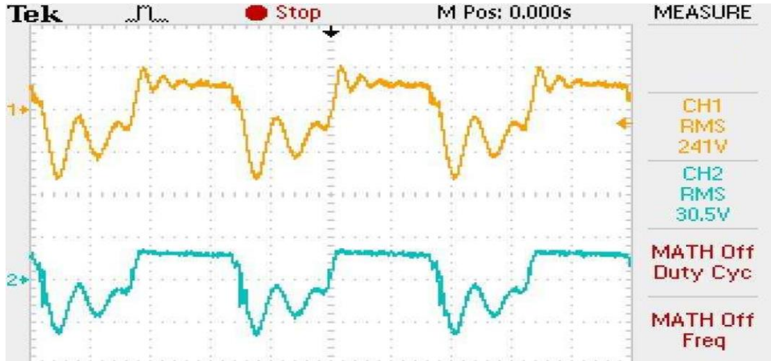
Рисунок 3.20 - Осцилограми вхідної та вихідної напруга трансформатора
