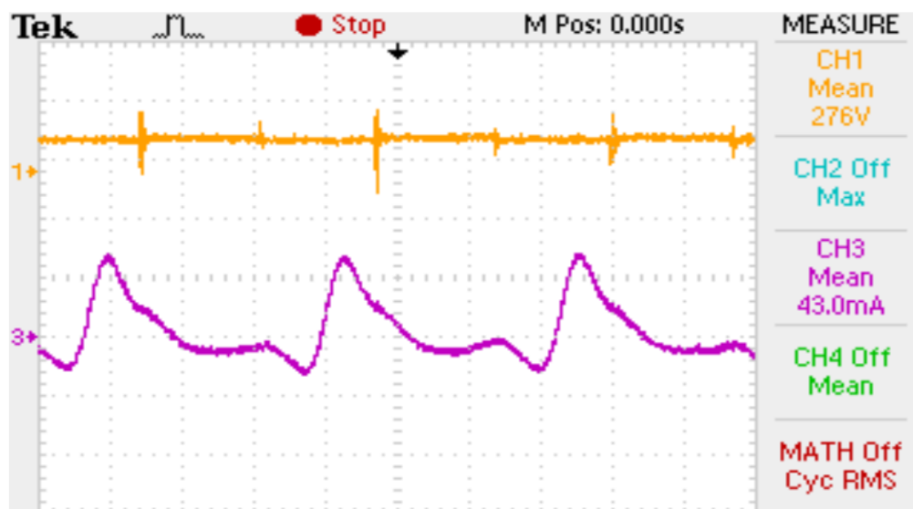
Рисунок 3.18 - Форма вихідної напруги перетворювача з коректором коефіцієнта потужності і струм на індуктивності i_{LB}
