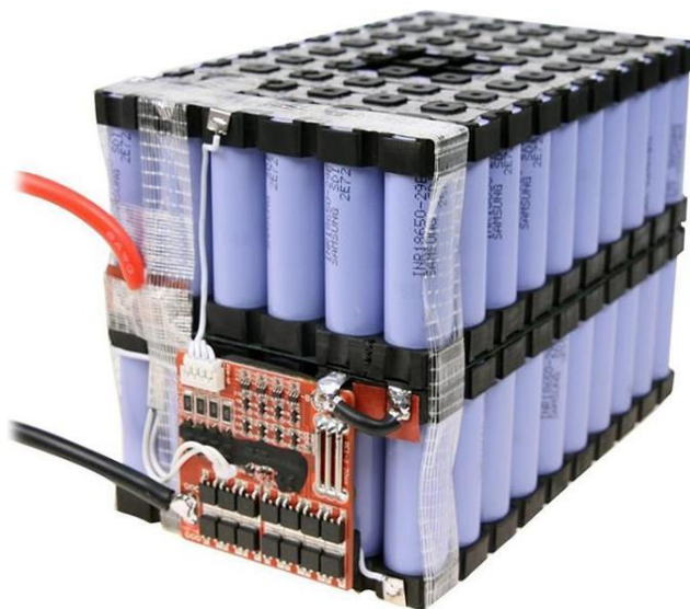
Рисунок 2.6 – Зовнішній вигляд літій-іонного акумулятора зібраного із елементів 18650 з BMS
