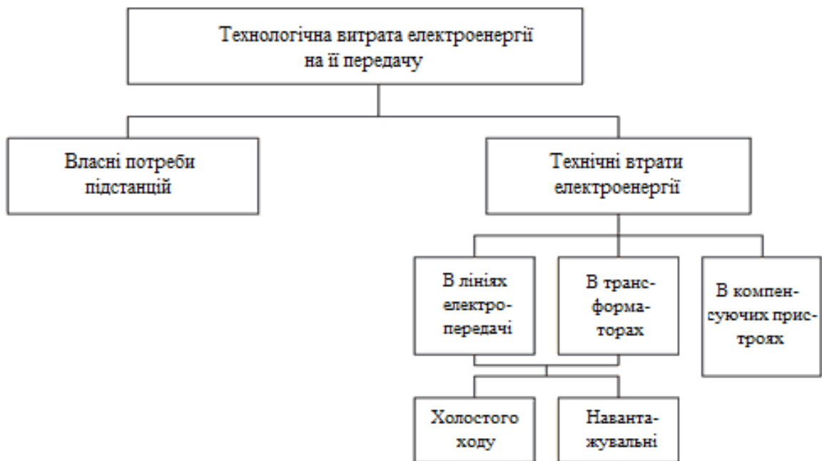
Рисунок 1.1 - Структура витрати електричної енергії на її передавання
