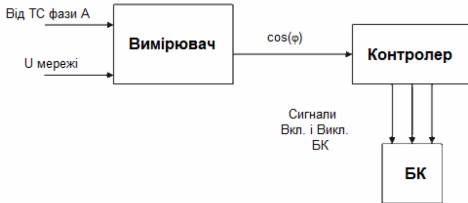
Рисунок 2.2 - Структурна схема пристрою керування конденсаторною установкою
