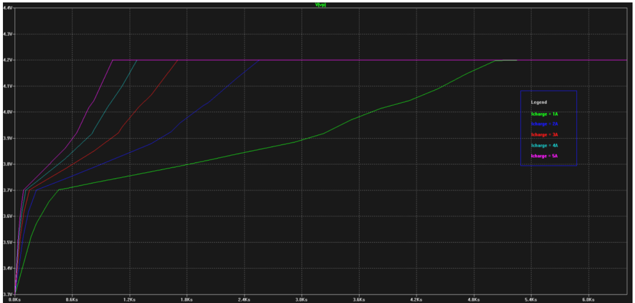
Рисунок 3.8 - Криві процесу зарядки літій-іонного акумулятора для різних значень струму
