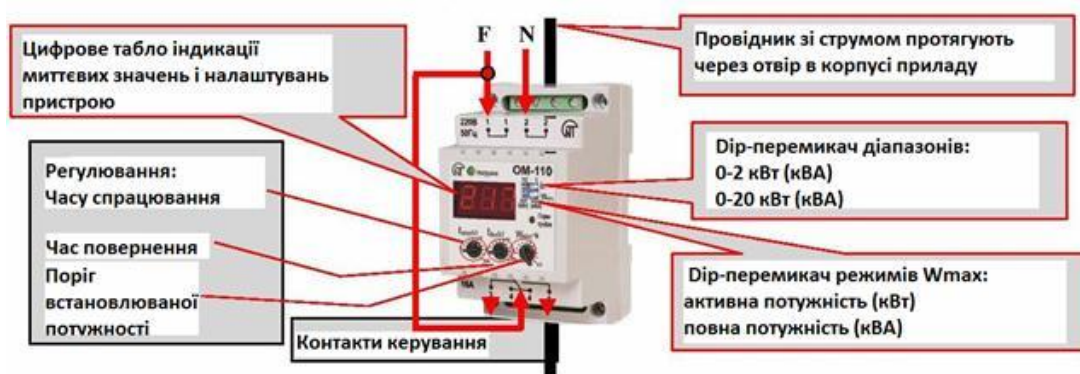
Рис. 6.1. Зовнішній вигляд і характеристики обмежувача потужності ОМ-110
