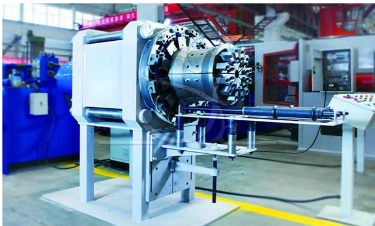
Рис. 2.11 – Установка горизонтального розвальцьовування
