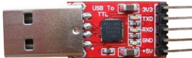
Рисунок 2.7 – Зовнішній вигляд перетворювача інтерфейсу на базі мікросхеми cp2102
