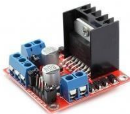
Рисунок 2.12 – Зображення модуля управління моторами RKP-01A на мікросхемі L298N
