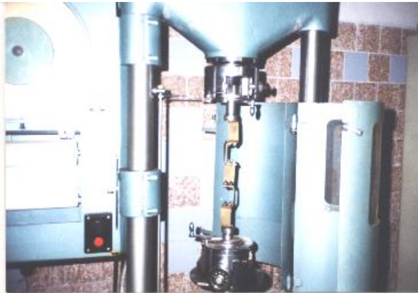
Рис.5. Загальний вигляд пружного вала при визначенні крутної жорсткості на розривній машині P-5.
