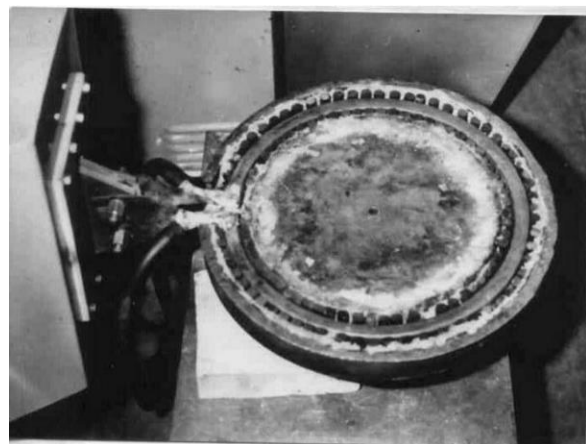
Рис.4. Нижня притискаюча плита з кільцевим індуктором і феритним магнітопроводом
