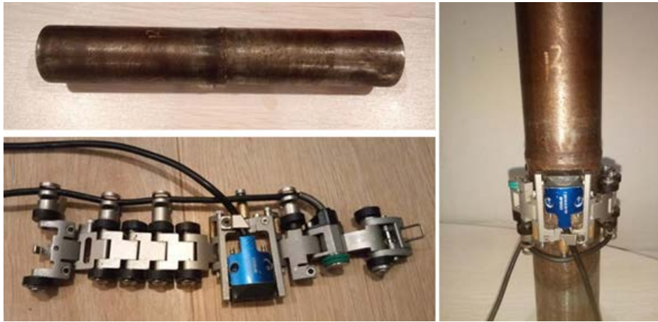
Рисунок 2.5 – Ланцюговий сканер та низькопрофільні датчики на фазованій решітці компанії TWN для УЗК труб малого діаметру
