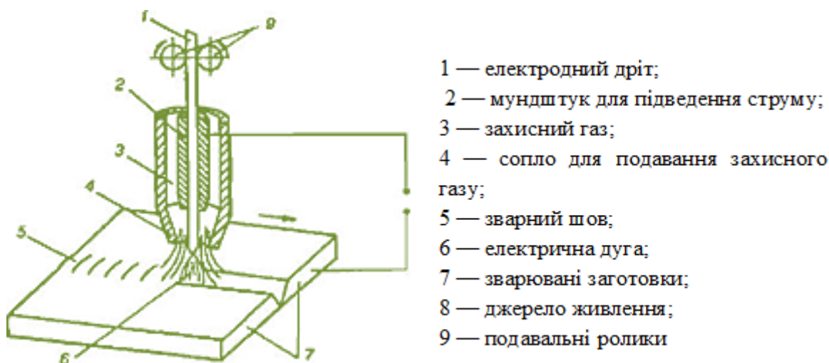
Рис. 2.2 Схема процесу дугового зварювання у захисному газі
