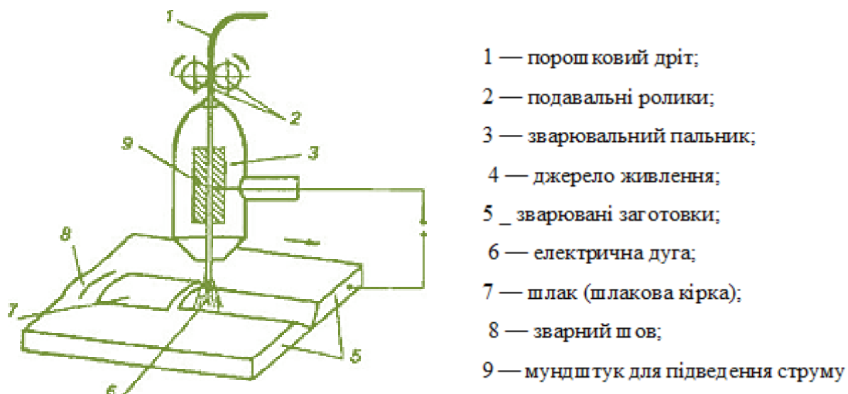
Рис. 2.4 Схема процесу зварювання порошковим дротом
