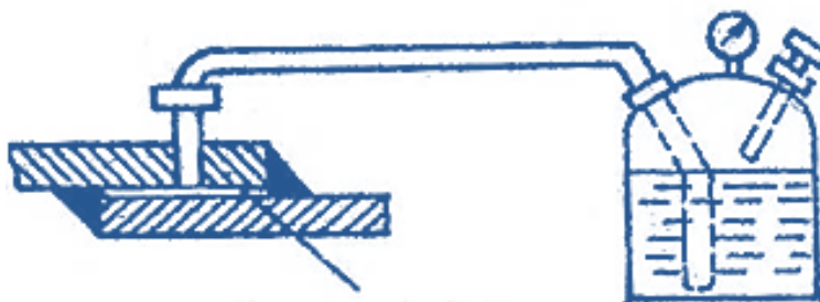
Рис. 2.6 - Схема випробувань на густину зварних швів повітрям [12]
