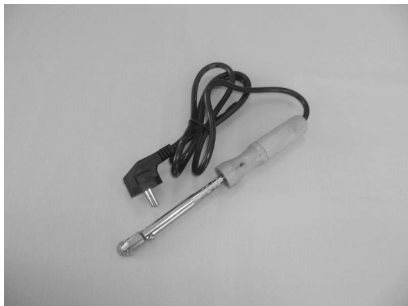
Рисунок 1.4 – Каток електричний для навощування "ПРО"
