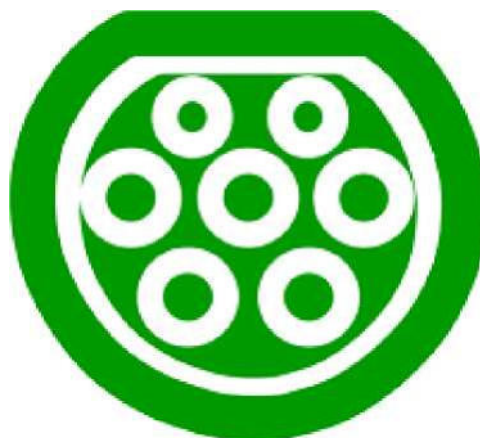
Рисунок 1.6 Тип роз'єму Type 2 Mennekes (Європа)
