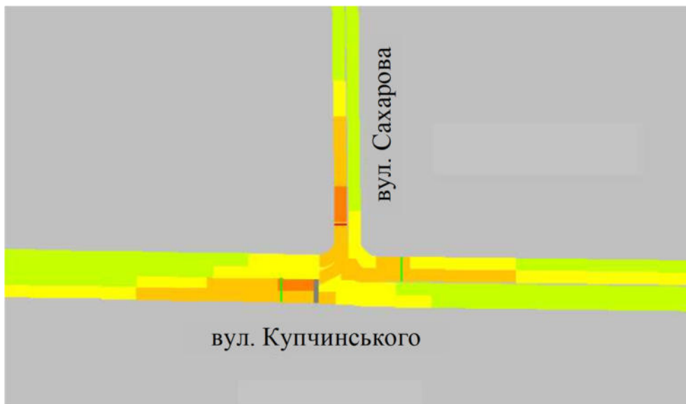
Малюнок 2.23 - Графічне колірне відображення стану транспортних потоків при проєктованій ОДР на перехресті вул. Купчинського – вул. Сахарова
