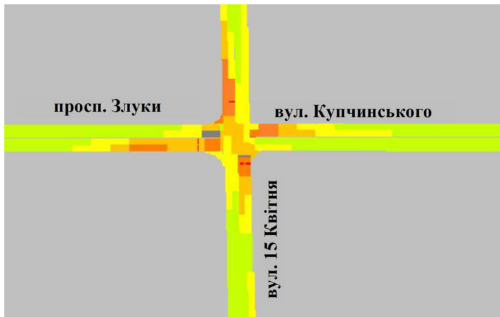
Малюнок 2.21 - Графічне колірне відображення стану транспортних потоків при проєктованій ОДР на перехресті вул. 15 Квітня – проспекту Злуки
