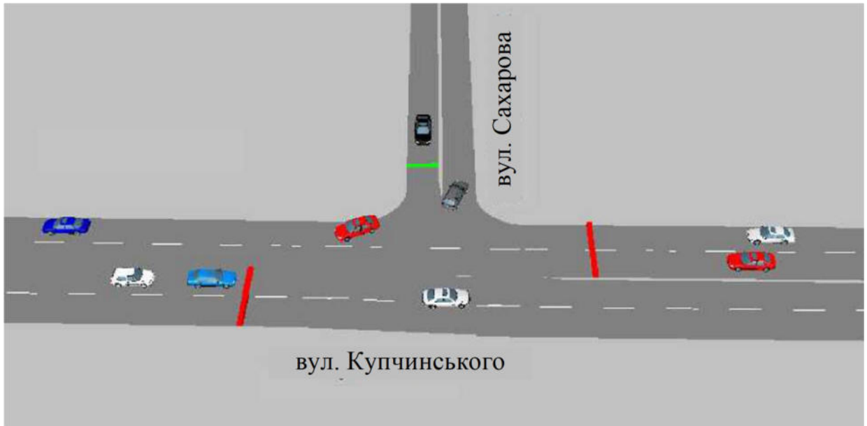
Малюнок 2.22 - Стан транспортних потоків при проєктованій ОДР на перехресті вул. Купчинського – вул. Сахарова
