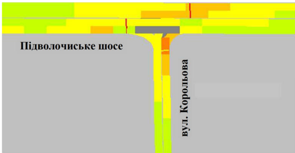
Малюнок 2.19 - Графічне колірне відображення стану транспортних потоків при проєктованій ОДР на перехресті вул. Корольова – Підволочиське шосе
