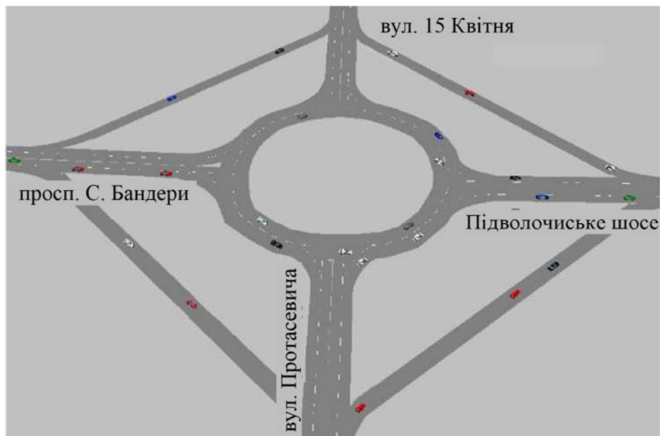
Малюнок 2.24 - Стан транспортних потоків при проєктованій ОДР на перехресті Збаразький поворот
