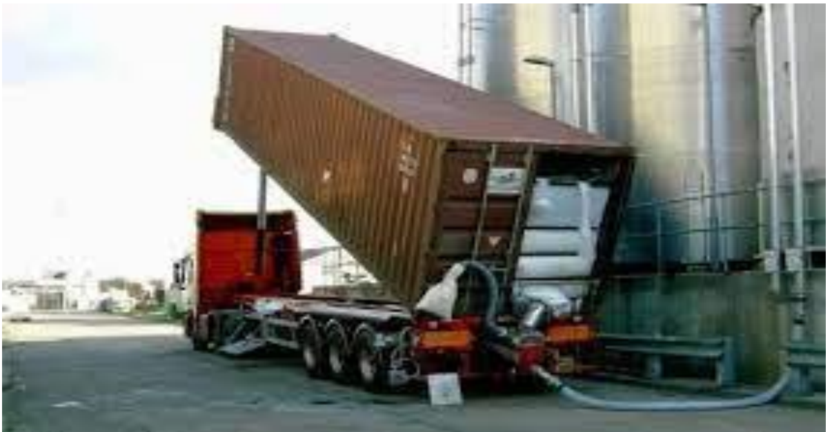
Рисунок 1.3 Процес наливання олії в автоцистерну
