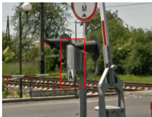
Рисунок 2.18 - Автоматизований придорожній сигнал через залізничний
