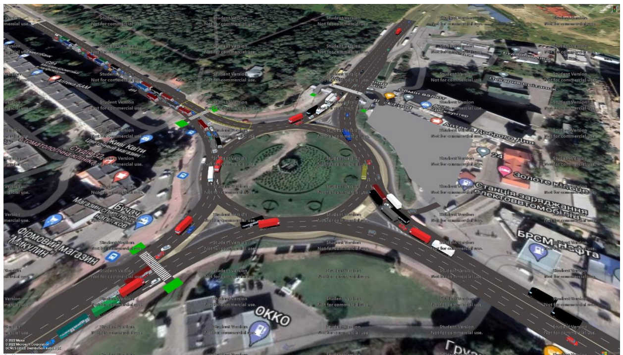
Рис. 2.9. 2D (а) та 3D(б) вигляд імітаційної моделі перехрестя із впровадженими заходами організації дорожнього руху
