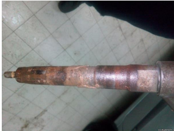
Рисунок 1.12 – Корозія форсунки і розпилювача
