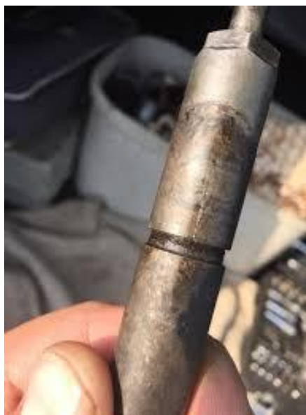
Рисунок 1.13 – Тріщина корпусу форсунки
