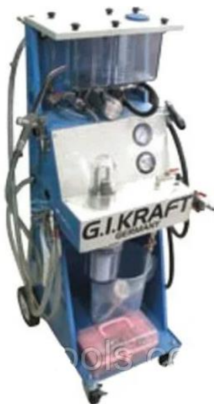
Рисунок 2.2 – Установка для промивки системи мащення G.I.KRAFT GI21111
