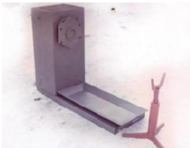
Рисунок 3.1 - Верстат моделі Р 642 для збирання і розбирання двигунів СМД-41
