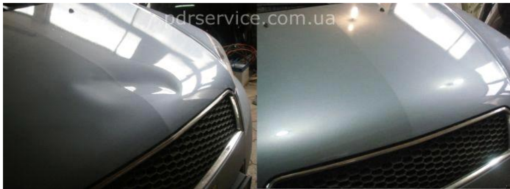
Рис. 2.7 Виправлення капоту, вирівнювання вм'ятин
