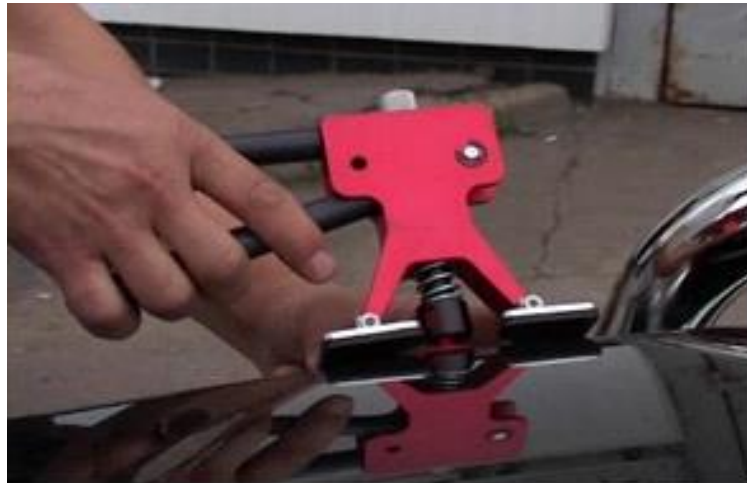
Рис. 2.8 Інструмент для виправлення пошкоджень-вм'ятин
