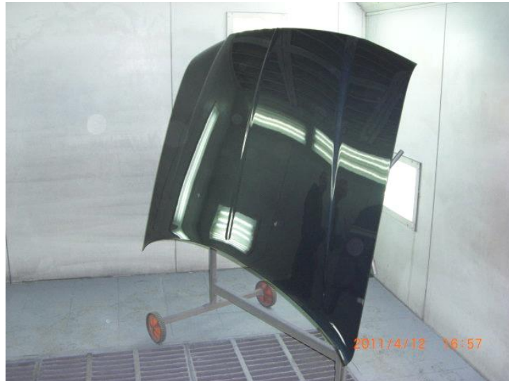
Рис. 2.5 Запікання фарби капоту після фарбування
