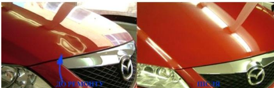
Рис. 2.6 Робота по видаленню вм'ятин
