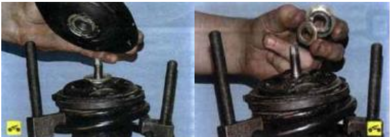
Рис. 2.5. Заміна верхньої опори та шайби.
