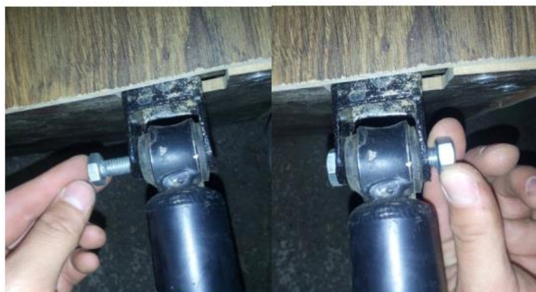
Рис. 3.11 – Встановлення амортизатора у нижнє кріплення
