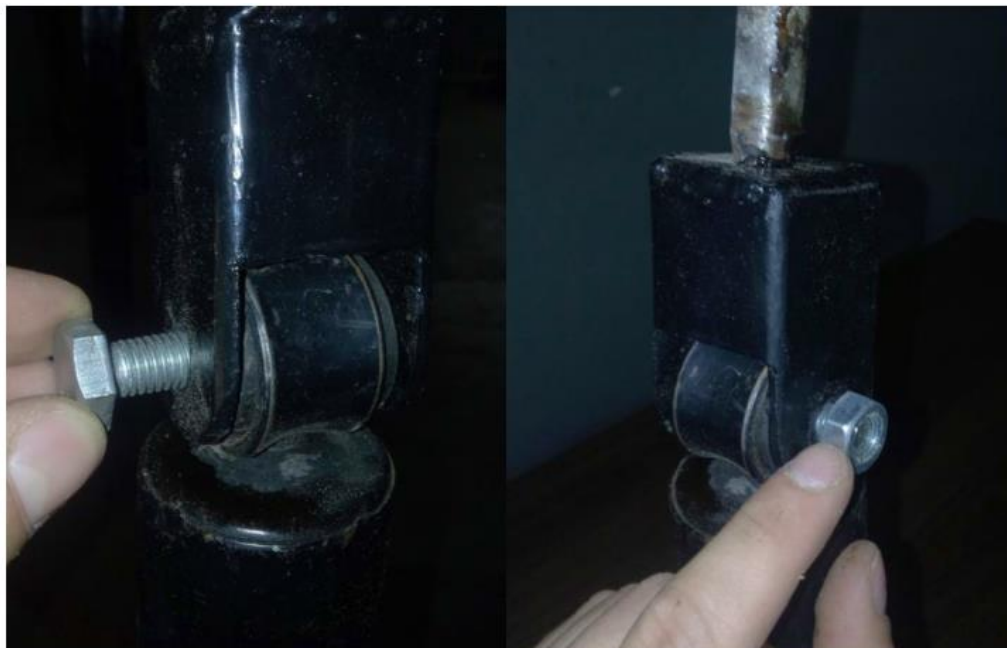
Рис. 3.9. Встановлення амортизатора у верхнє кріплення
