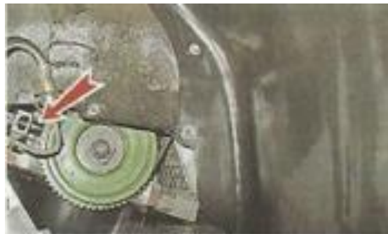
Рисунок 2.3 – Розташування датчика положення колінчастого валу
