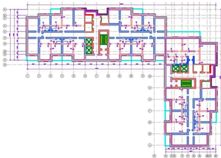
Рисунок 1.3 – Виконання перегородок з пінобетону
