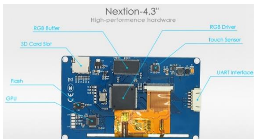
Рисунок 1.26 – Основні вузли дисплею.
