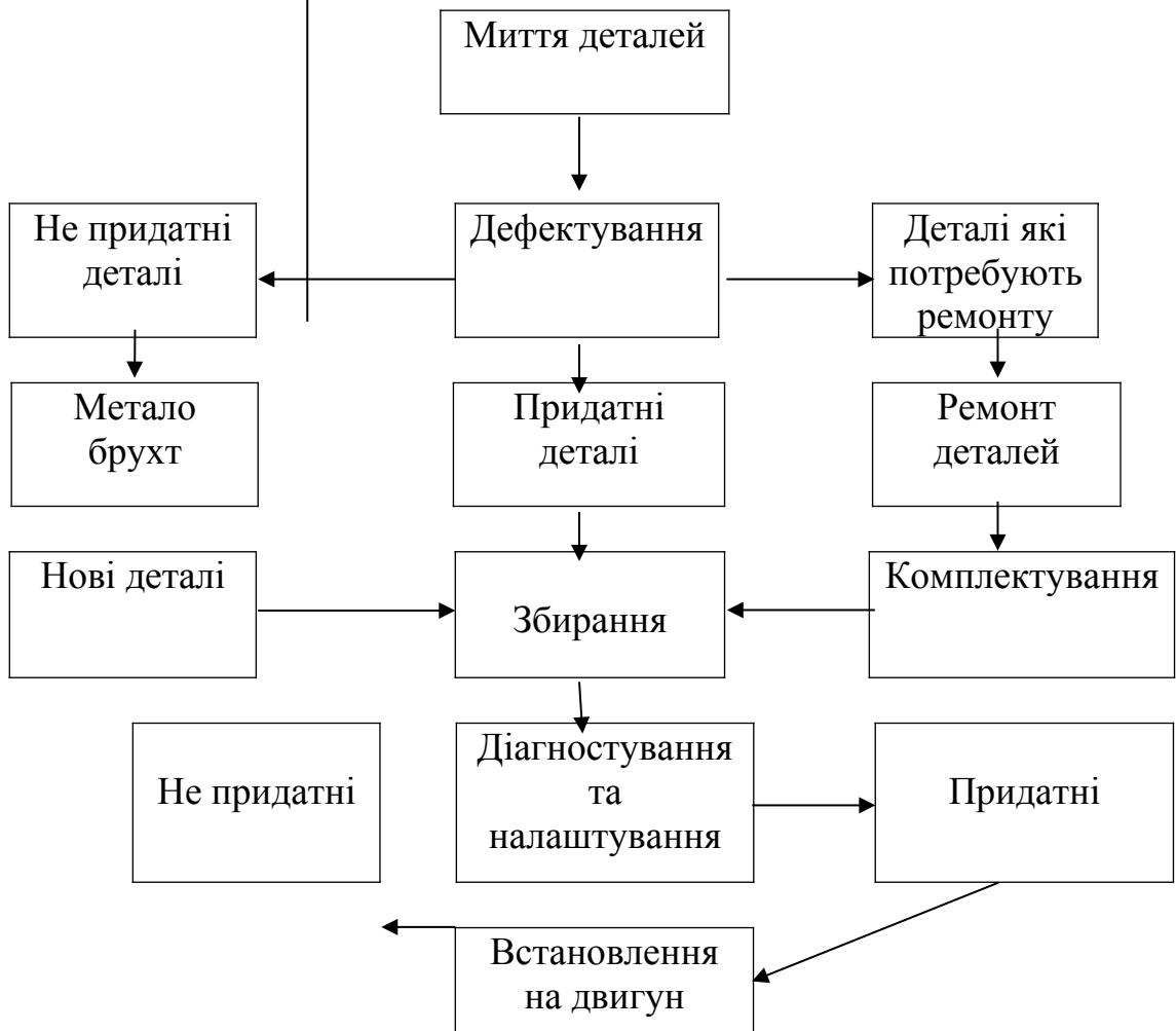
Рисунок 2.1 - Схема технологічного процесу ПР ПНВТ
