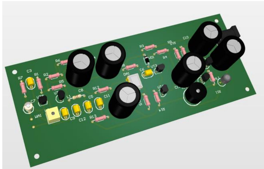
Рисунок 2.3 – 3D модель друкованої приймача Altium Designer
